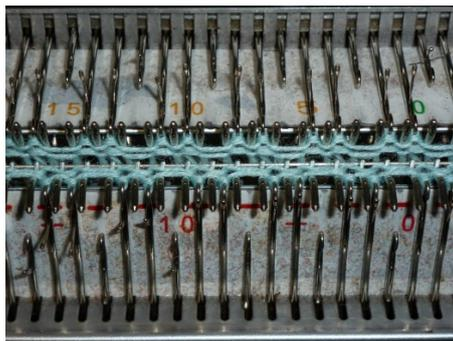
MW 5 an beiden Betten, Feinstrickhebel I, Rundstricktasten lösen, die Zusatzmasche vom DB auf die Nadel gegenüber vom Hauptbett hängen und gewünschte Reihenanzahl stricken.
