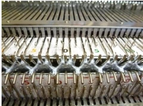
MW 5/5 II, 14 Reihen stricken. Dann die Maschen vom DB auf eine Nadel der Zweiergruppe vom Hauptbett dazuhängen, DB absenken und Einbettabstreifer anbringen. MW 4. Die MW wird in den folgenden Reihen jeweils um einen Punkt verkleinert, 6 Reihen stricken. Auf dem rechten Bild seht ihr, wie das Gestrick für die „Krone“ dann aussieht.
