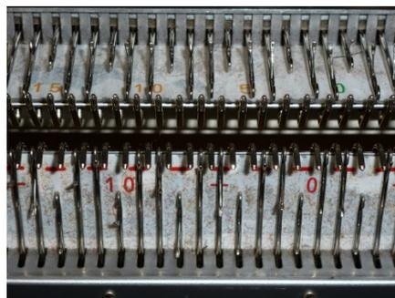
Nadelbett um eine ganze Stufe nach links versetzen, am DB 1 Nadel dazu wählen, so daß diese Nadel zwischen den ersten beiden des Hauptbettes steht; MW 0 an beiden Schlitten, am DB Feinstrickeinstellung auf II, Netzreihe stricken.
