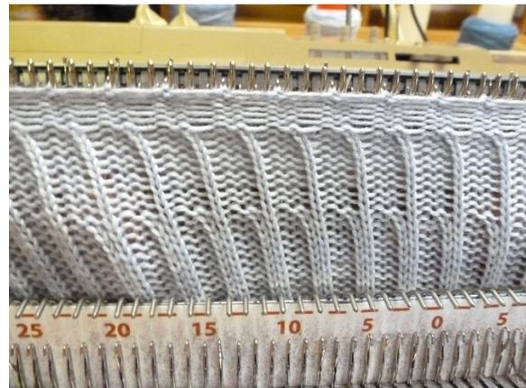
Nun die 2 Maschen auf eine Nadel nehmen, so daß jetzt nur jede 3. Nadel belegt ist, eine Reihe in unveränderter MW stricken, Faden etwas länger abschneiden und in die Umhängenadel fädeln. Die Maschen alle damit auffädeln und zusammenziehen. Rückwärtige Naht mit Matratzenstich schließen, für den Umschlag von der linken Seite, damit die Naht dort nicht außen liegt.
